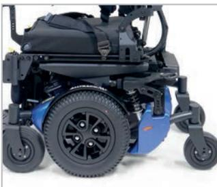
Konfiguration mit Mittelantrieb und interaktiver Federung der 6 Räder und des Sitzes für mehr Stabilität, Mobilität und Komfort.
